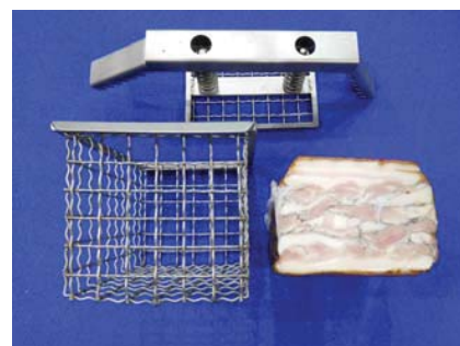
Рис. 5. Формованный продукт из двух пластов грудинки с использованием дополнительного мясного сырья и его пресс-форма
